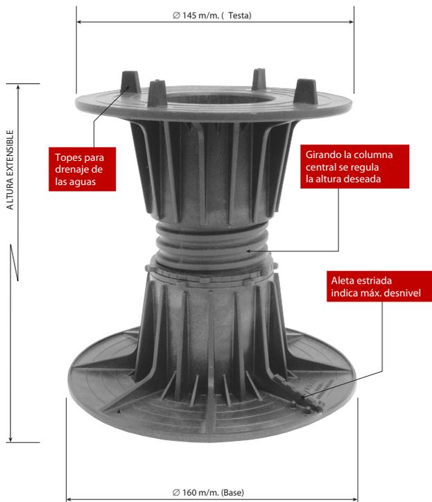
La obtención de los 3 elementos que forman el conjunto se fabrican por termo-inyección.
