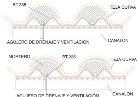
Si por estética no se desea que el perfil de la placa Onduline se vea la retrasaremos unos 20-30 cm. del alero. Por debajo de la placa Onduline y hasta el alero insertaremos una chapa de zinc o una chapa de plomo que haga de babero. Las posibles filtraciones bajarán por la placa Onduline, pasarán a la chapa de zinc o de plomo y desaguarán al canalón. Si se decide amorterar el alero tome las medidas aconsejadas en el párrafo anterior.
