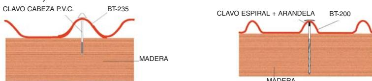
Si las correas son metálicas las placas Onduline se fijan con un tornillo autorroscante o con gancho y arandela.
