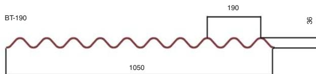
Para tejas de ancho de boca mayor de más de 22 cm. se coloca la placa impermeabilizante BT-190.
