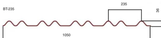
Para tejas de ancho de boca mayor entre 18,5 y 22 cm. se coloca la placa impermeabilizante BT-235.
