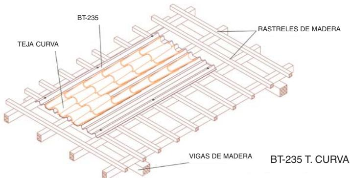
La placa se fija al soporte con el CLAVO ESPIRAL o con el CLAVO CABEZA PVC. La fijación se debe realizar siempre en la parte alta de la onda y a golpe de martillo (al clavo espiral hay que añadirle una ARANDELA ONDULINE).
