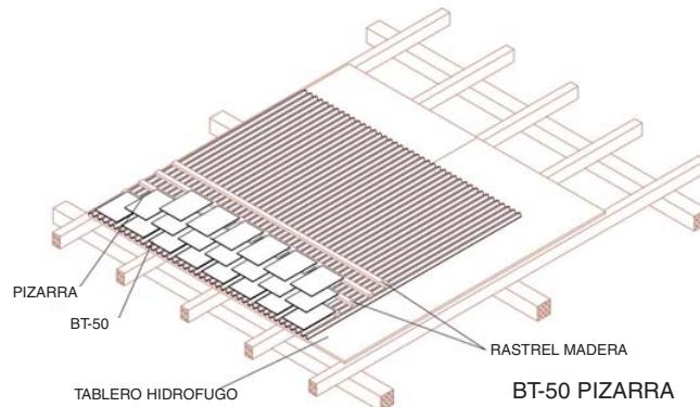
La placa Onduline y el listón se fijan con el CLAVO y ARANDELA ONDULINE adecuado al tipo de soporte. La fijación se debe realizar siempre en la parte alta de la onda y a golpe de martillo.
