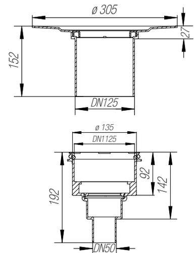
Conjunto de desagüe DN 50 sin sifón con brida de fijación para la construcción de un sistema de drenaje de 2 niveles para agua en superficie y de filtración en combinación con el cuerpo del desagüe. Capacidad de desagüe 1,4 l/s (84 l/min) con rejilla/marco de acero inoxidable D1
