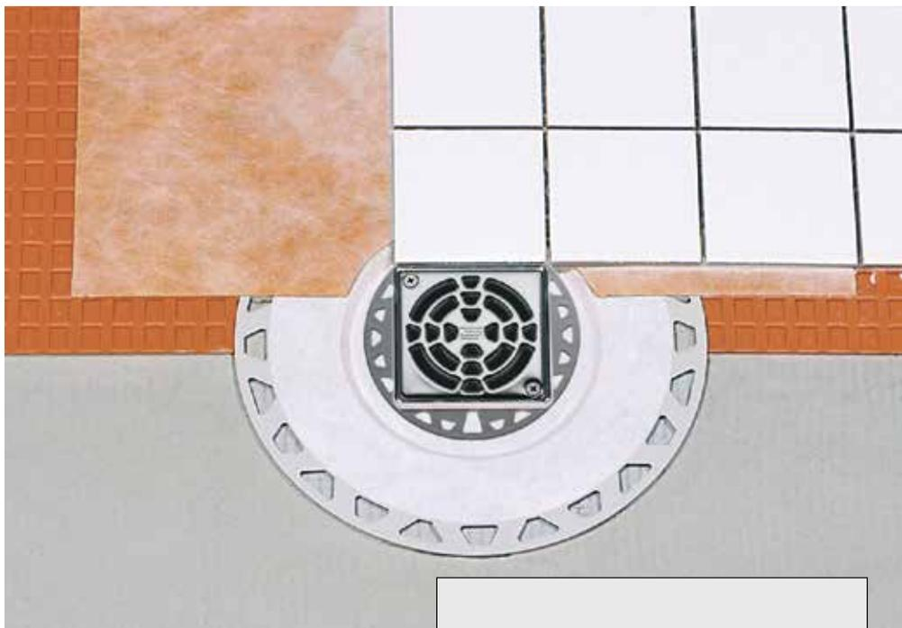
(ABS) y cuenta con una brida de sujeción cuya superficie está recubierta con geotextil. El manguito de impermeabilización Schlüter®-KERDI de PE flexible, está recubierta de geotextil por ambas caras para lograr una buena adherencia de las baldosas cerámicas a través del adhesivo. La rejilla de acero inoxidable se fabrica en V2A (Material 1.4301 = AISI 304) y en V4A (material 1.4404 = AISI 316L).
