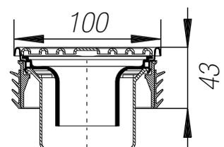
Pieza portadora de acero inoxidable para recubrimientos, con soporte y sifón integrado
