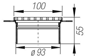
Marco de contorno con rejilla de diseño de acero inoxidable PURE, con soporte y anillo de fijación de altura Marco de contorno de 100 x 100 mm, posibilidad de desplazamiento en todas las direcciones para grosores de 3 a 30 mm
