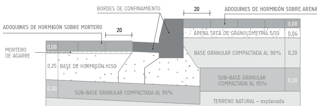
\*Sección tipo: calidad explanada E1 (5<CBR<10: explanada deformable). Nivel tráfico C1 (25 a 49 vehículos pesados por día)
