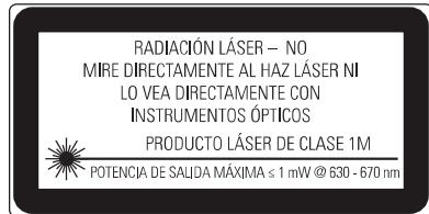
**NO** retire ninguna de las pegatinas de advertencia de la carcasa. Este instrumento únicamente debe usarse para las tareas de nivelación y diseño, como se describe en este manual.
