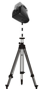
1. Roscas de instalación de 1/4 - 20 hilos para acoplar la unidad láser.
