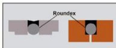
Fondo de junta fabricado con un polietileno expandido de celdas cerradas. Utilizado para relleno o limitador de profundidad en el sellado de juntas de dilatación, acristalamiento, fachada, pavimento. Dando tope al material con el que realice el sellado.
