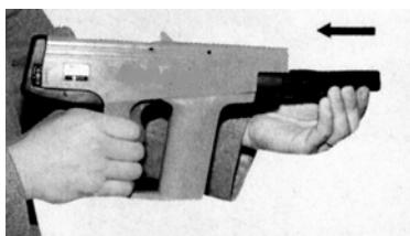
3º Colocar previamente el Amortiguador Buterola (C-05) en el Portaclavos (C-01).
