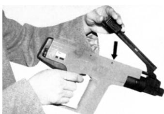
7º Cuando la rosca llegue cerca del fondo, balancear el brazo Remontador de Clavos (B-02) a su posición de cierre, el conector y el pestillo del gancho se unirán automáticamente de nuevo.
