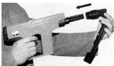
5º Deslizar la Base Portaclavos + Remontador de Clavos (B-01), sobre el Portaclavos (C-01).
