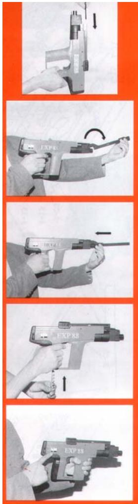
1º Colocar la herramienta en posición vertical, con el portaclavos hacia arriba, e insertar el clavo con la punta hacia abajo en el “introductor”, deslizándolo hacia el interior del mismo
