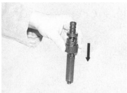
*Si usted usa clavos demasiado cortos, impulsores demasiados potentes, ó el material de base tiene diferentes durezas, el clavo resultara aplicado con exceso de potencia de impulsión. En caso de daños en el amortiguador, este deberá ser sustituido.*
