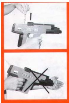
**El peine de impulsores de la herramienta debe ser retirado siempre de la misma, antes de realizar desmontaje, montaje, cambio de piezas, etc., así como a diario ó cada vez que se acabe un trabajo. El peine se extrae tirando desde la parte superior de la herramienta.**
