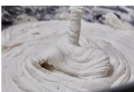
Amasar **webercol dur** con la cantidad de agua limpia indicada en la tabla final, por saco de 25 kg, con un batidor eléctrico lento (500 rpm) hasta obtener una masa homogénea y exenta de grumos. Dejar reposar la mezcla unos 2 minutos y realizar un ligero reamasado.
