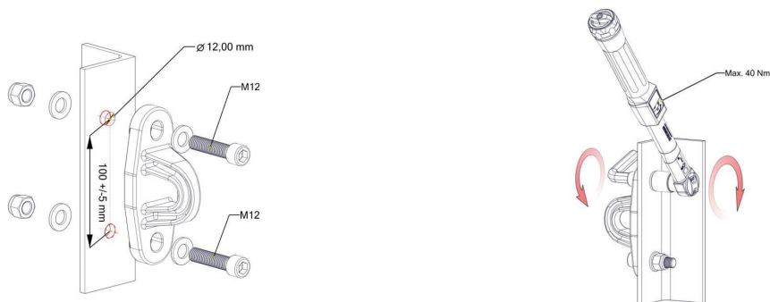
Figura 3. Instalación de sujetadores de pernos con punto de anclaje sobre estructura de acero
