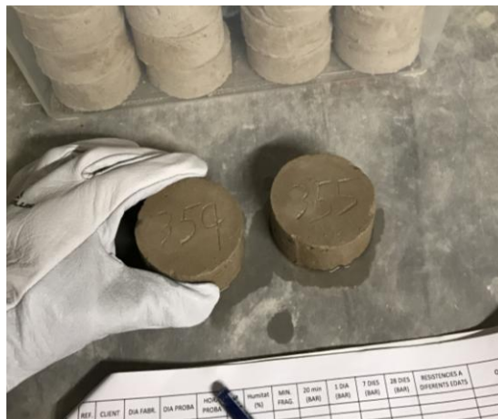
Registro y clasificación de probetas para el control interno
