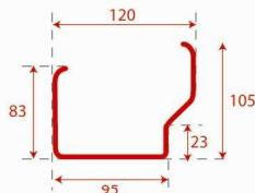
**"EUME":** sistema de canalón de gran capacidad con una bajante cuadrada de Ø 70x70 y/o circular de Ø 90.
